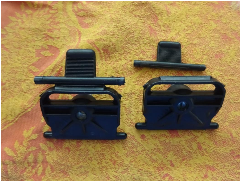
Bild 6: Intakter (aus einem /8) und kaputter Abblendmechanismus
