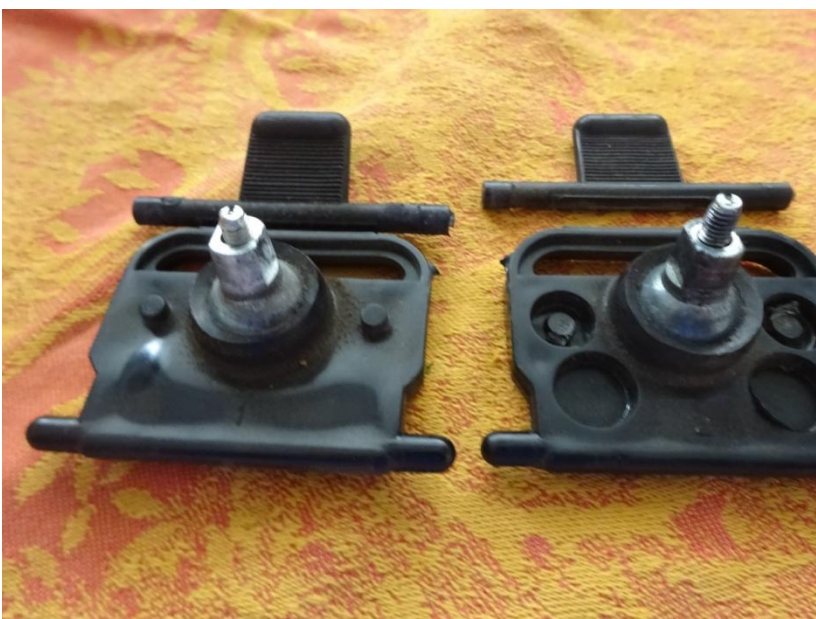
Bild 7: Abblendmechanismus mit Kugelpfanne
