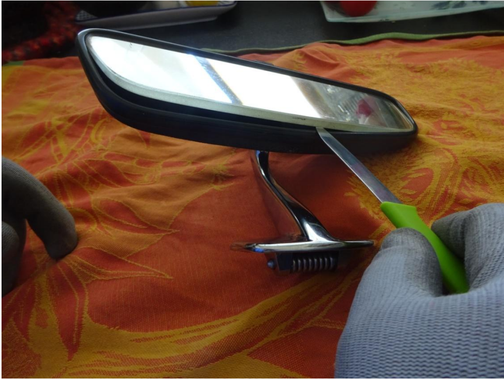
Bild 3: Dünnes Küchenmesser zum Aushebeln benutzen
