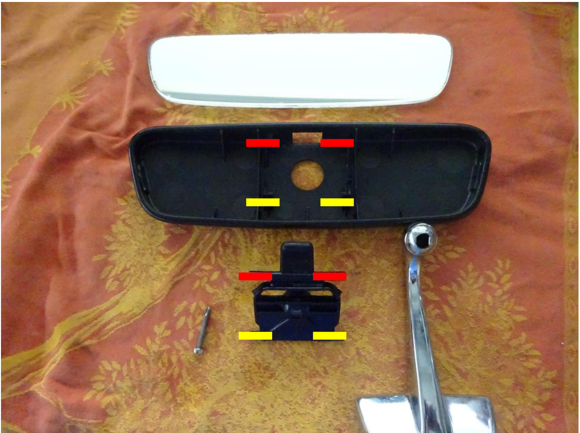
Bild 8: Einzelteile des Spiegel
