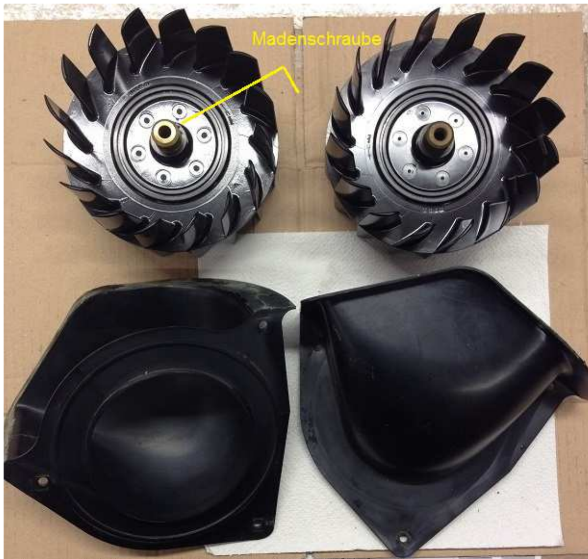
Lüfterräder und Luftführung montieren - Einbaulage der Lüfterräder beachten (Lufttrichtung!)
