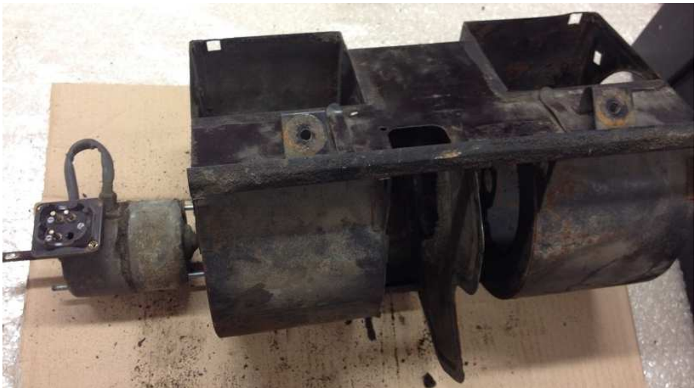
Motorleitung ausfädeln und Motor herausnehmen
