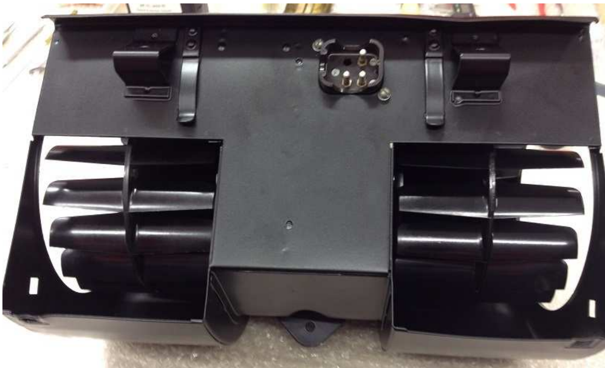
Lüfterräder und Luftführung montieren - Einbaulage der Lüfterräder beachten (Lufttrichtung!)
