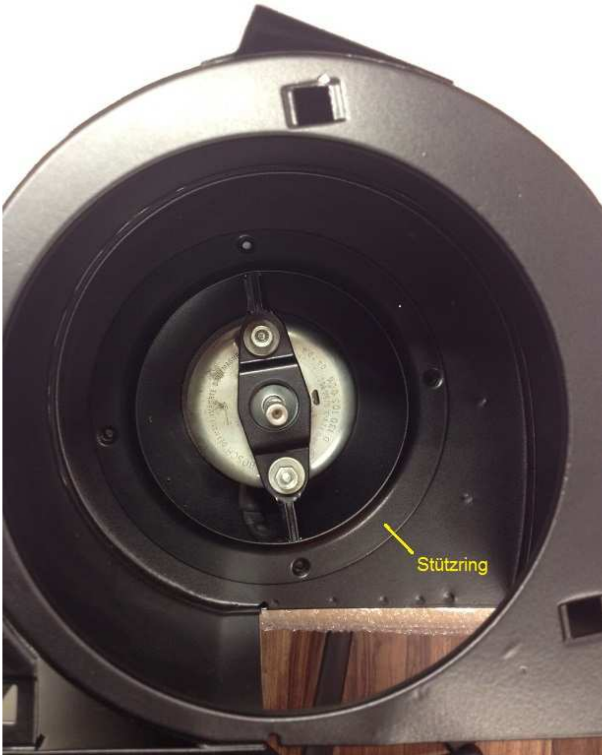
Motor mit Stützring eingebaut
