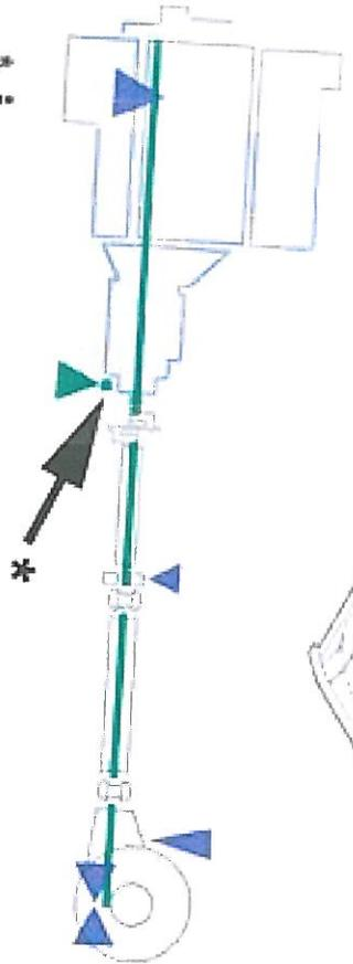
**!** Zur Einstellung der Kardanwellenfucht ist Ermittlung der richtigen Distanzscheibe(n) am Getriebe-Gummilager wichtig. Zustand/Position angrenzender Aggregate-Aufhängungen (z.B. Fahrstempel an Karosserie) verändern zusätzlich die vertikale Lage und an mehreren Stellen ist neben der vertikalen auch eine horizontale Einstellung möglich. Zu hohe Motor-Arme (Limousinen-Motor) und fehlende Anschlagplatten verhindern richtige Einstellung und führen zu Schäden an der SL-Motorhaube.
