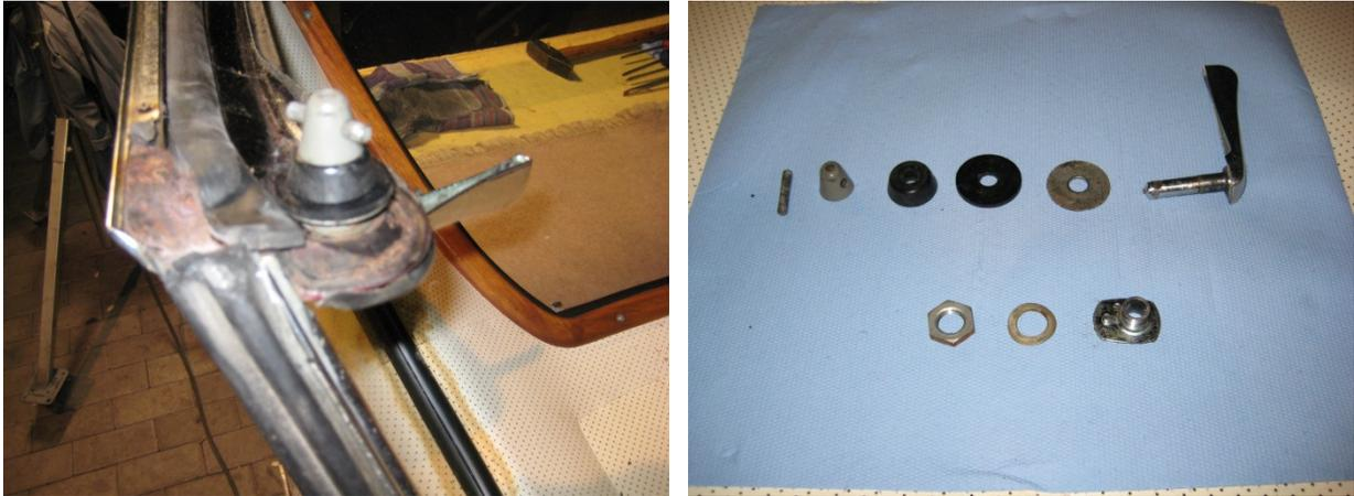
Spätestens jetzt sollte man vor dem weiteren Zerlegen und der Demontage der Chromleisten tunlichst für eine geordnete und beschriftete Aufbewahrungsmöglichkeit der diversen Schrauben sorgen! Das Hardtop verfügt (incl. Zierleisten Dach) über insgesamt 21 Zierleisten sowie eine Aluleiste unter dem vorderen Dachhimmel. Die Leisten sind mit zum Teil sehr unterschiedlichen Schraubenformaten befestigt. Nicht alle davon sind noch lieferbar. Wer hier also nicht aufpasst, hat später ein Problem.
