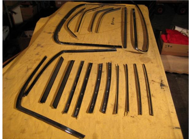
Für das Blechdach folgen nun in der Regel Sandstrahlen, Schweißen und Lackieren. Darauf achten, ob die kleinen Blechnasen vorne am unteren Hardtoprahmen neben den Verschlüssen noch vorhanden sind. Dort wird das untere Dichtungsende eingesteckt.
