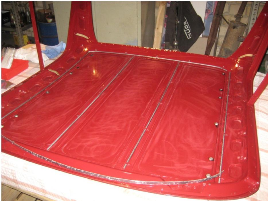
Die vordere Aluleiste wird sichtbar, sobald der am vorderen Dachrahmen verklebte Himmelstreifen von vorne abgezogen wurde.
