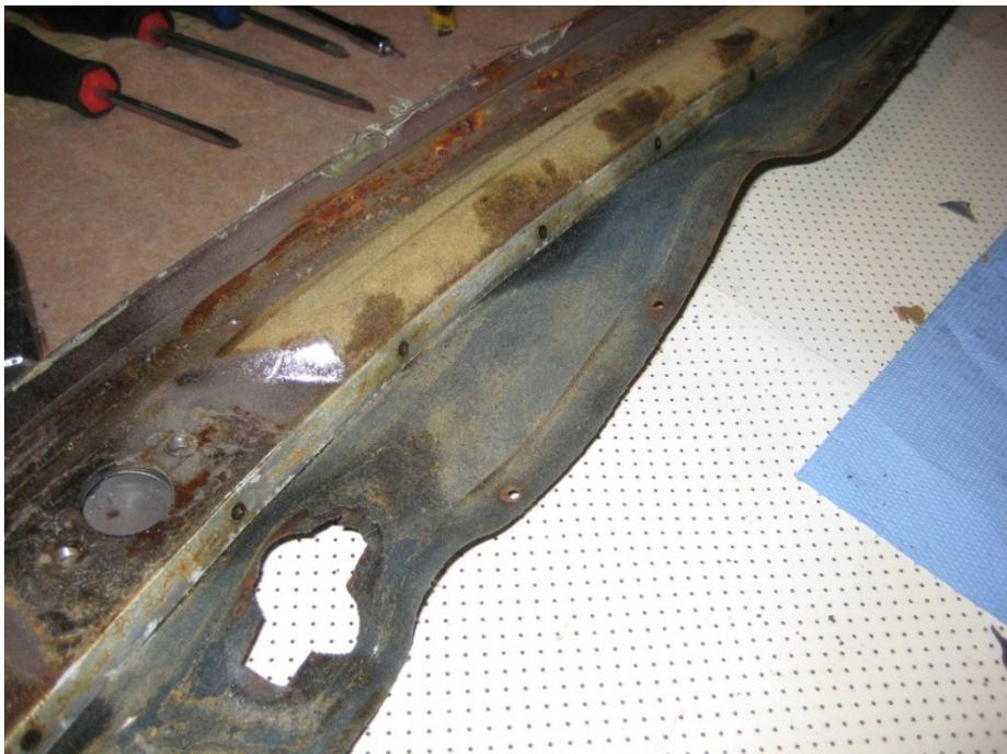
Soweit vorhanden, können nun auch die Zierleisten des Daches abgeschraubt werden. Je Seite sind sie mit sechs Schrauben befestigt, die zur Freude des Restaurierers satt in Dichtmasse sitzen. Hat man sie zerstörungsfrei heraus bekommen, lassen sich die Dichtmassenreste daran meist anlösen, wenn man die Teile längere Zeit in WD 40 einlegt.
