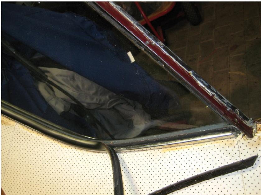
Die zweite ist die Hauptdichtung, welche um den gesamten Scheibenrand herumgezogen ist. Sie lässt sich i. d. R. nicht beschädigungsfrei demontieren, also wird sie zerschnitten und die Teile werden herausgezogen. Danach lässt sich die Scheibe herausnehmen und die Verschraubungen der oberen Chromleiste sind zugänglich.
