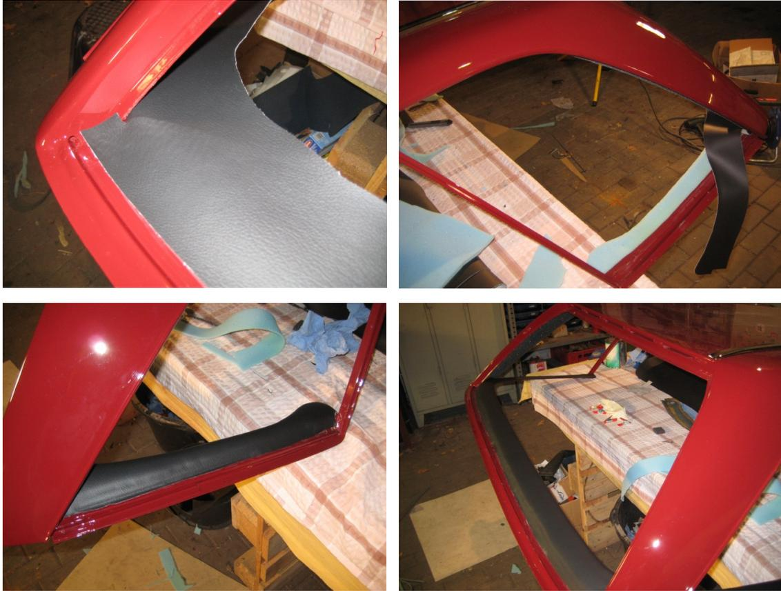
Danach wird der Himmel eingezogen. Hierfür zunächst die Spiegel einziehen sowie die vier seitlichen Haltelaschen. Da die Altteile aus Pappe meist nicht mehr zu verwenden sind, lässt sich Ersatz aus einem etwas dickeren Kunststoffeimer zurechtschneiden. Dann den Himmel einhängen und grob ausrichten.
