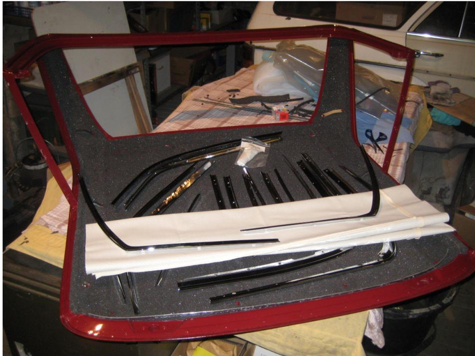
Danach wird die Polsterung unterhalb der Seitenscheiben sowie unter der Heckscheibe verklebt – ebenfalls mit Sattlerkleber. Wer Echtleder verwenden möchte, sollte bedenken, dass der Bezug unter der Heckscheibe einteilig ist. Es wird also eine große Fläche (ca. eine halbe Haut) mit erheblichem Verschnitt benötigt. Kunstleder geht genauso gut (sh. Fotos) und kostet nur einen Bruchteil. Der Bezug wird mit 5 mm Schaumstoff unterfüttert.
