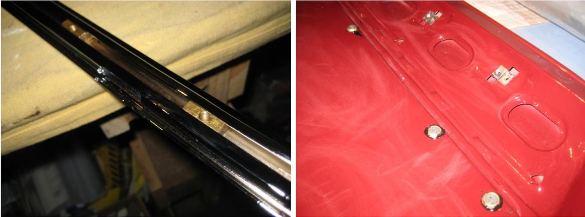
Als nächstes wird die Dämmung eingeklebt. Entsprechendes Dämmmaterial gibt es bei MB. Alternativ geht auch rd. 8 mm dicker Schaumstoff. Zum Einkleben Sattlerkleber verwenden!
