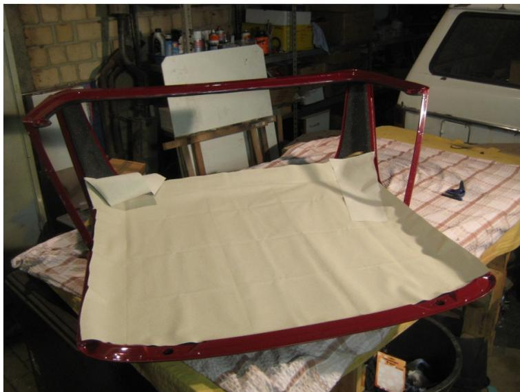
Anschließend den Himmel hinten mit Klammern spannen und fixieren und ihn vorne im Bereich unterhalb der Aluleiste von innen nach außen verkleben und die Leiste aufschrauben. Die Leiste wird später für das Anbringen des vorderen Himmelstreifens noch einmal gelöst.
