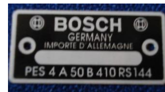
Typenschild Bosch Schild data-plate Einspritzpumpe PES 4
