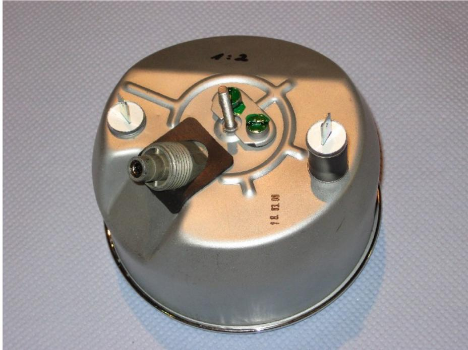
Auf der Unterseite befindet sich die Schraubverbindung für den Anschluss der DZM-Welle. Rechts und links befinden sich die Öffnungen für die beiden Glühbirnen mit ihren Fassungen. Mittig sitzt die Schraube für die Rändelmutter zur Fixierung der Halteklammer (sh. unten) und für den Anschluss des Massekabels. Die Klammer hat links eine Öffnung und rechts einen Ausschnitt für die Lampenfassung, bzw. -zuleitung.
