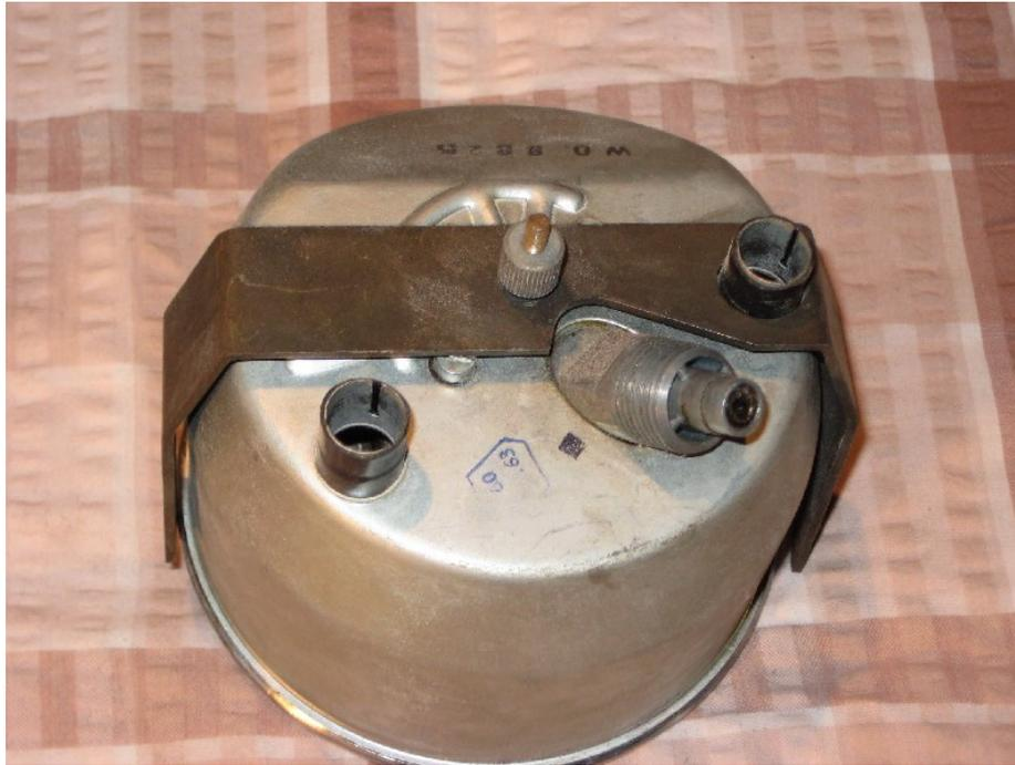
Wie beim Drehzahlmesser gibt es auch hier zwei Öffnungen für die Lampen, den Schraubanschluss für die Welle und eine per Rändelmutter fixierte Halteklammer.
