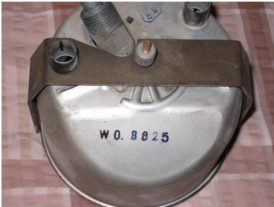
Darüber hinaus ist die entsprechend der Hinterachsübersetzung erforderliche Wegstreckenangabe des Tachos auf das Gehäuse aufgedruckt.
