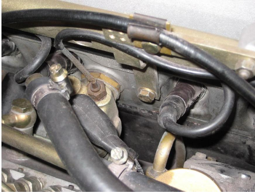
Dann kann die weitere Demontage über die Öffnung des entfernten Drehzahlmessers erfolgen. Zunächst die Öldruckleitung am Kombiinstrument abschrauben. Ggf. einen Lappen unterlegen, falls etwas Öl austropfen sollte. Dann Halteklammer lösen, herausnehmen und das Kombiinstrument vorsichtig samt Kapillarleitung und der Leitung des Mehrfachsteckers nach vorne herausnehmen. Die Kapillarleitung dabei vorsichtig durch die Tülle in der Stirnwand führen / ziehen.
