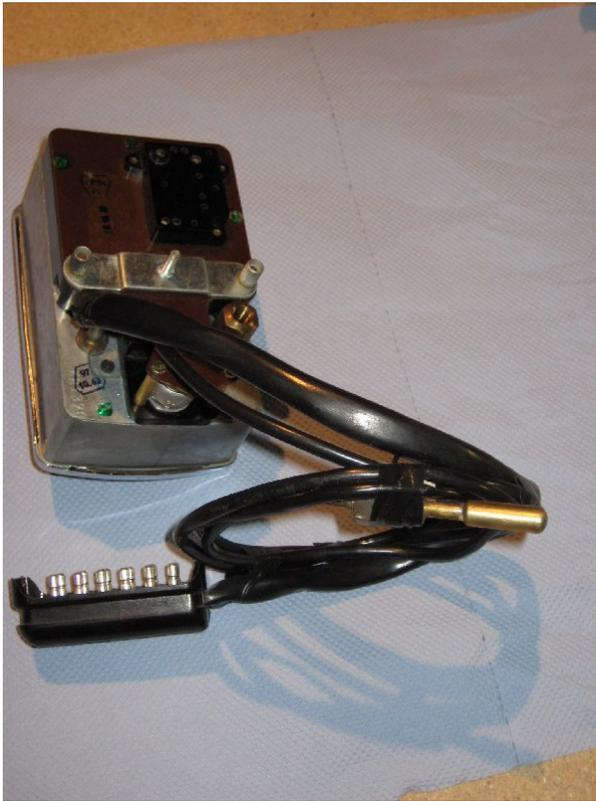
Mittig befindet sich auch hier die Schraube für die Rändelmutter zur Fixierung der Halteklammer. Auf der rechten Seite befindet sich direkt unterhalb der Klammer der Kabelausgang für den Mehrfachstecker. Direkt daneben liegt die Kapillarleitung für die Kühlwassertemperaturanzeige. Sie sollte wie ein rohes Ei behandelt werden. Eine Beschädigung zieht in der Regel den Komplettaustausch des Fernthermometers nach sich.
